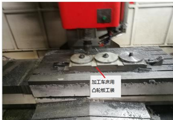
图 6 同时加工三个零件的夹具设计案例
